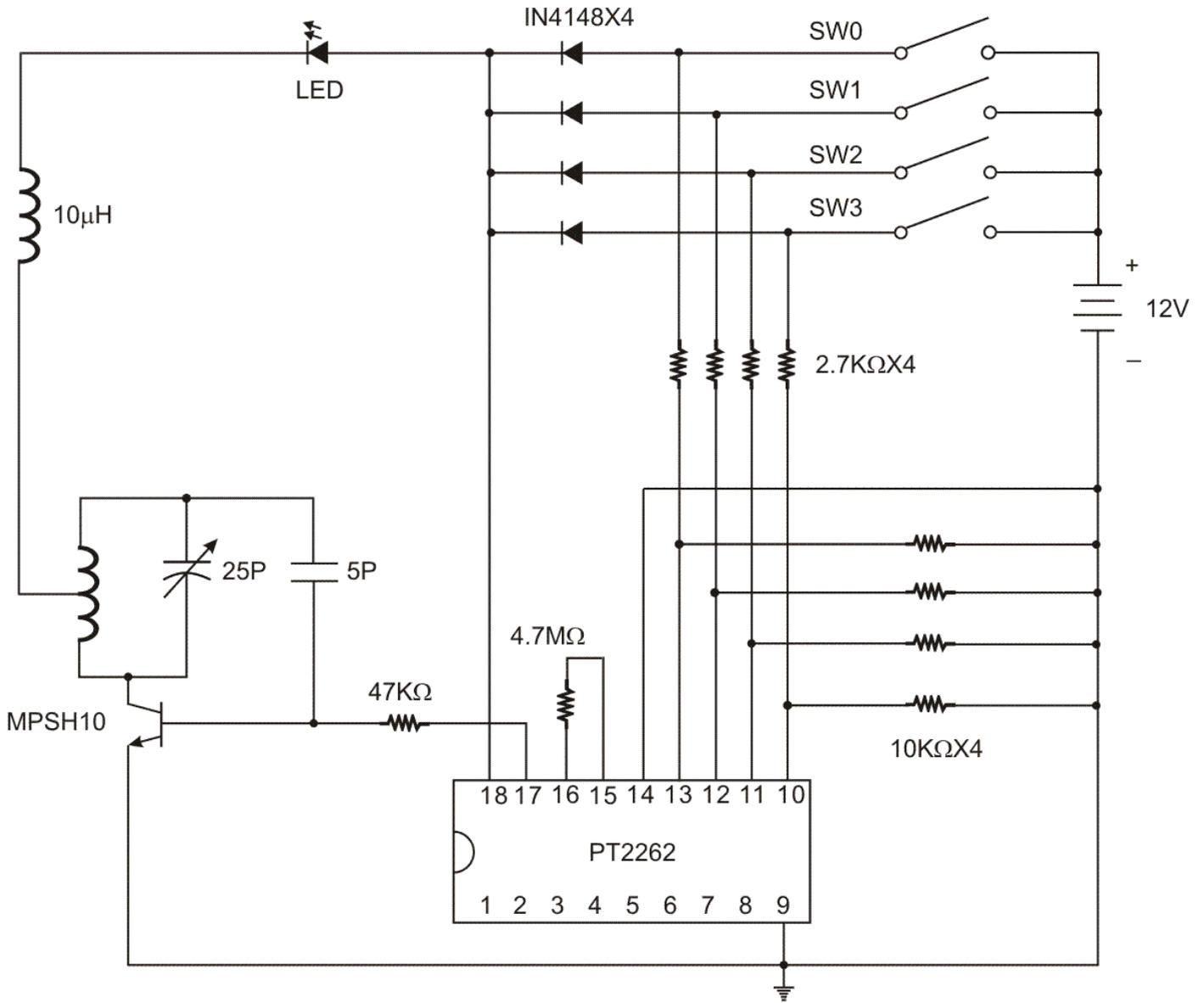
***UHF BAND ADDRESS-ONLY (ZERO DATA) TRANSMITTER CIRCUIT IS RECOMMENDED***
