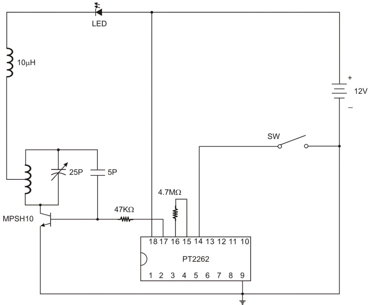
**UHF BAND ADDRESS-ONLY (ZERO DATA) ZERO-STAND-BY TRANSMITTER CIRCUIT IS RECOMMENDED.**
