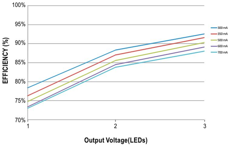
Fig-2 24VDC input, 1~7 LEDs(Vf=3V)
