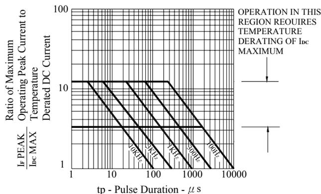
Fig.2 MAXIMUM TOLERABLE PEAK CURRENT VS. PULSE DURATION
