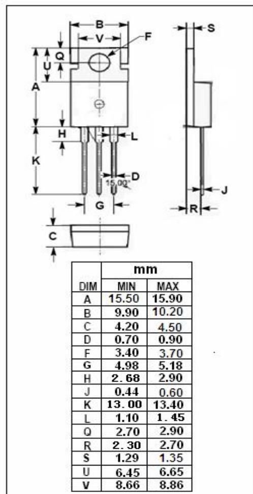
**isc N-Channel MOSFET Transistor****IRFB4710, IIRFB4710****ELECTRICAL CHARACTERISTICS** $T_c=25^\circ\text{C}$  unless otherwise specified
