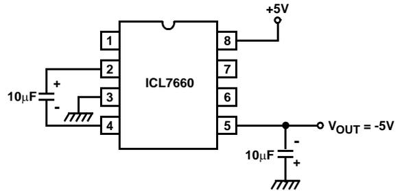
FIGURE 12. GENERATING A NEGATIVE SUPPLY FROM +5V
