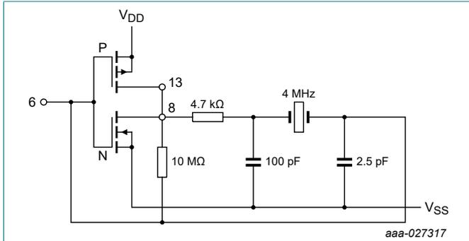
Fig. 10. 4 MHz crystal oscillator
