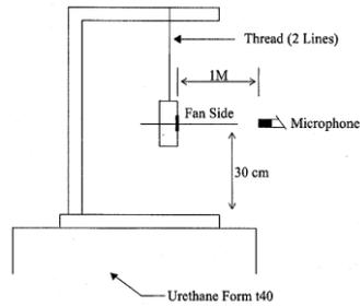
1 METER FROM MICROPHONE TO FAN INTAKE
