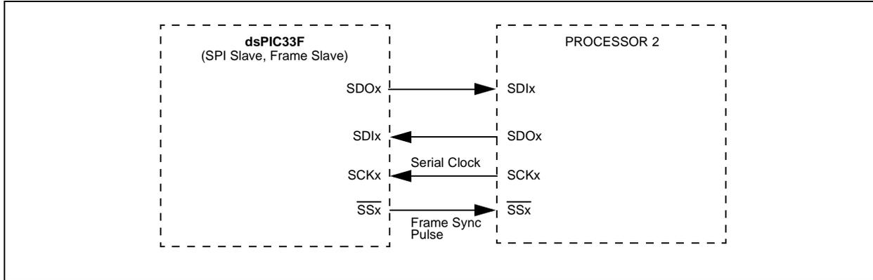
**FIGURE 13-6: SPI SLAVE, FRAME SLAVE CONNECTION DIAGRAM**
