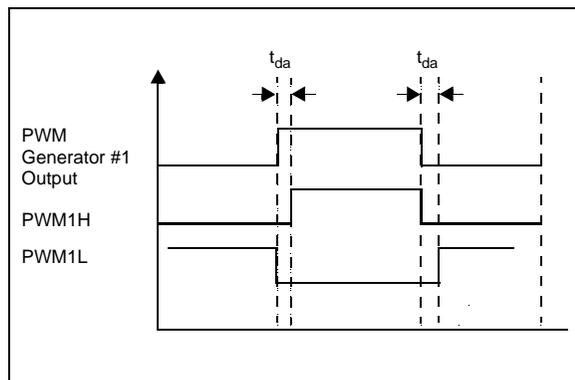
**FIGURE 12-16: DEAD-TIME CONTROL UNITS BLOCK DIAGRAM**
