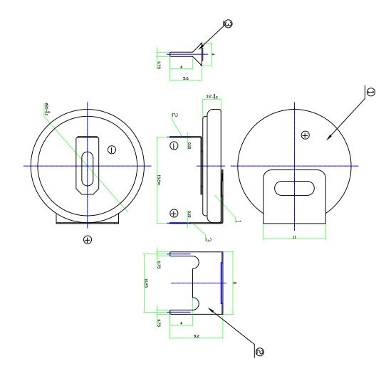
NOTE: 1. THE LITHIUM BATTERIES MUST MEET THE REQUIREMENT 2. THE BATTERY POSITIVE MUST BE FULLY COVERED WITH THE PVC SHEET ON THE NEGATIVE OF SINGLE CELL ωΝ LEAD TAG BATTERY 18.5\*11\*0.15 15.5\*4\*0.15 ø20.0\*3.2
